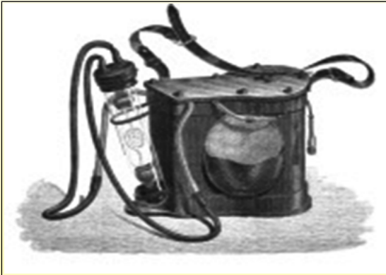
1862 Dumas et Benoît's Electrical miner lamp
